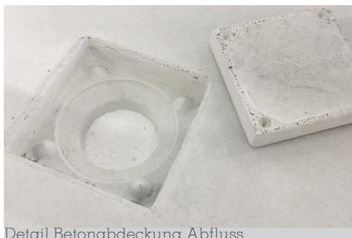
Detail Betonabdeckung Abfluss
